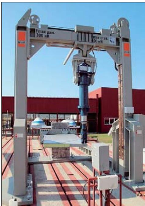
*При механических нагрузках коррозионные процессы проходят более интенсивно. Для испытаний крупногабаритных элементов конструкций под открытым небом в Геленджикском центре климатических испытаний в 2012 году введён в эксплуатацию уникальный автоматизированный комплекс.*
