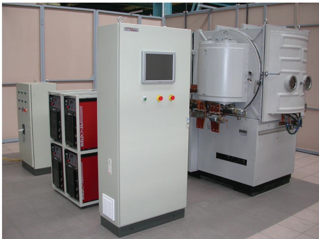
Установка ВИАМ-МЭШ-50 для нанесения ионно-плазменных покрытий на длинномерные лопатки ГТУ и другие детали ГТУ и ГТД
