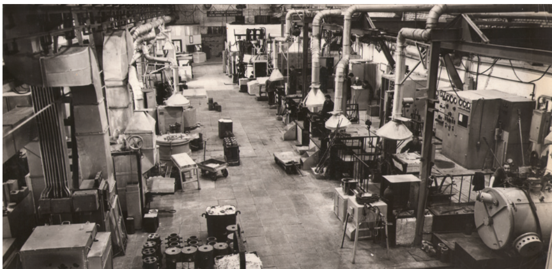
Участок индукционных печей сталелитейного цеха ВИАМ (1950 г.)
