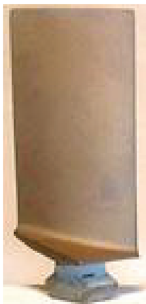
Лопатка компрессора двигателя РД-33МК с покрытием после испытаний на коррозию
