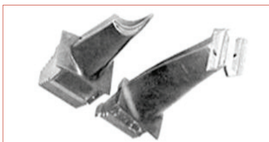
Лопатки турбины с запаянными знаковыми отверстиями
