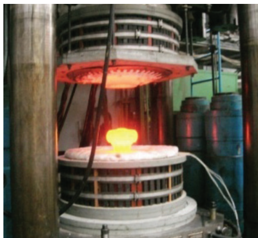
Специализированные прессы усилием 1600 и 630 тс, с программным управлением процессами нагрева заготовок и штамповок
