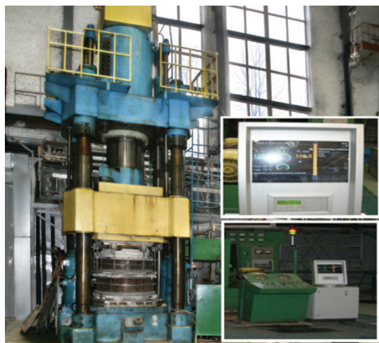
Специализированные прессы усилием 1600 и 630 тс, с программным управлением процессами нагрева заготовок и штамповок
