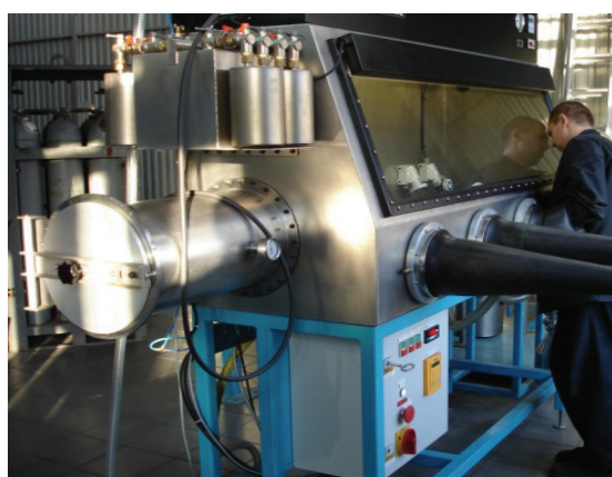
Система классификации и упаковки порошков в аргоне
