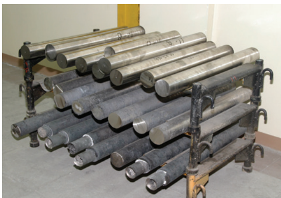
Внешний вид заготовок, получаемых в установке VIM 50 (внизу — после разливки в трубы; в середине после отрезки усадочной раковины;верху — после шлифовки поверхности)
