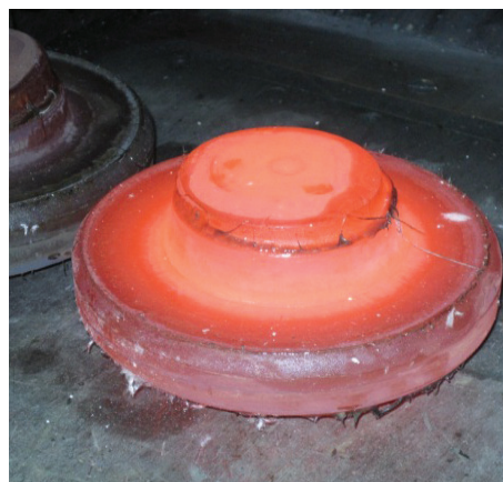
Штамповка диска из жаропрочного сплава ВЖ175 со сверхпластичным защитно-смазочным стеклопокрытием ЭВТ-108М
