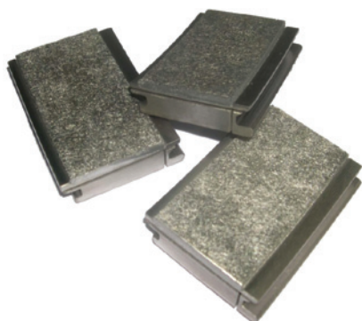
Элементы сектора разрезного кольца с нанесенным уплотнительным материалом из дискретных волокон системы \text{Fe-Cr-Al-Y}
