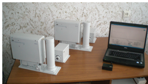
Рентгеновская установка ИСС 1003М для непрерывного контроля содержания связующего при пропитке препрегов
