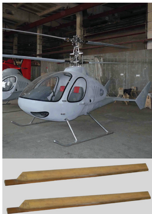
Вертолёт «Беркут» — лопасти из стеклопластика
