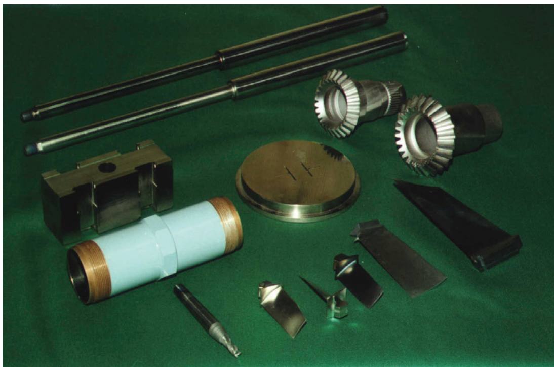
Пиролитическое карбидохромовое покрытие на сложнопрофилированных деталях
