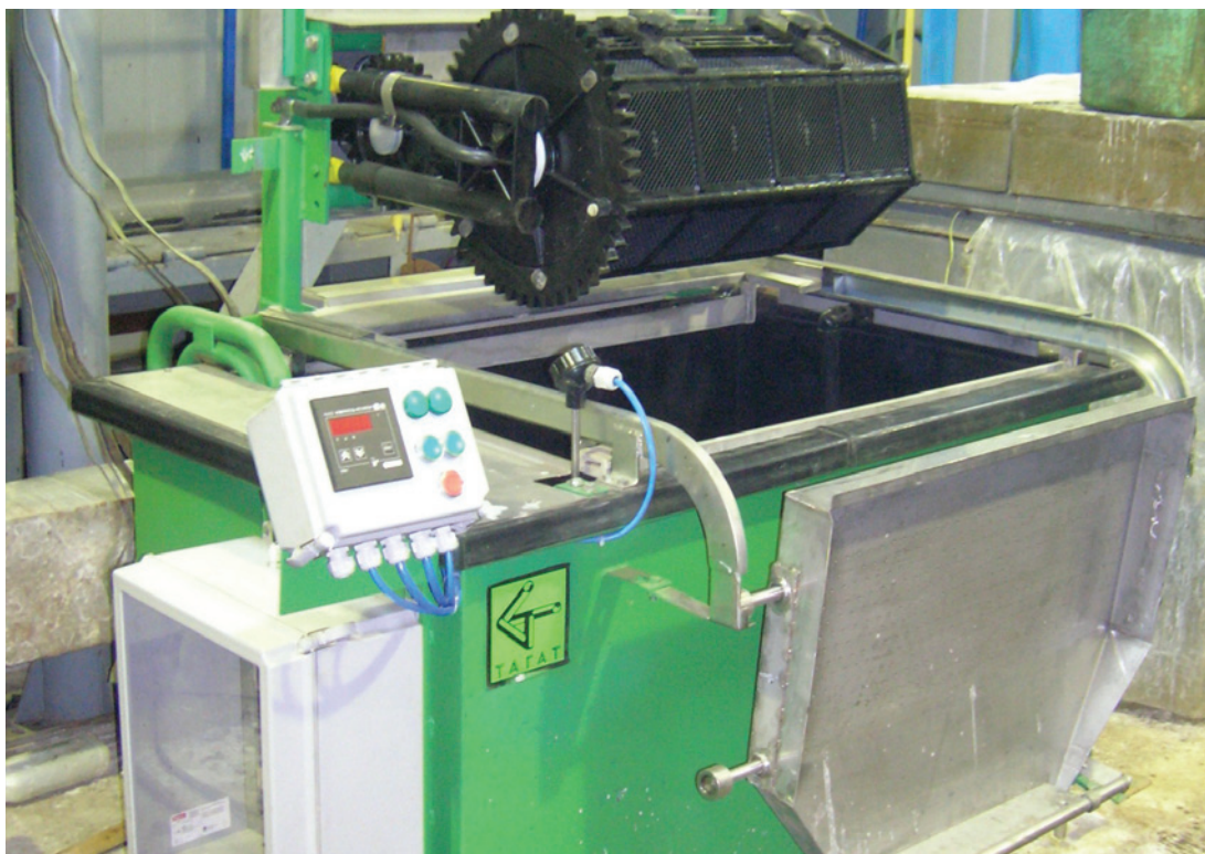
Установка УПН-3 (барабанного типа) для нанесения гальванических покрытий
