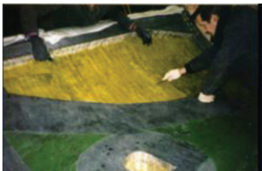
Нанесение клея на внешнюю обшивку
