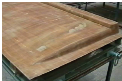
Полимерная выклеечная оснастка со встроенными неметаллическими нагревателями для изготовления конструкций интерьера самолета Ту-204-200
