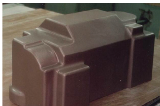
Стеклопластиковая оснастка для изготовления деталей из ПКМ способом контактного формования
