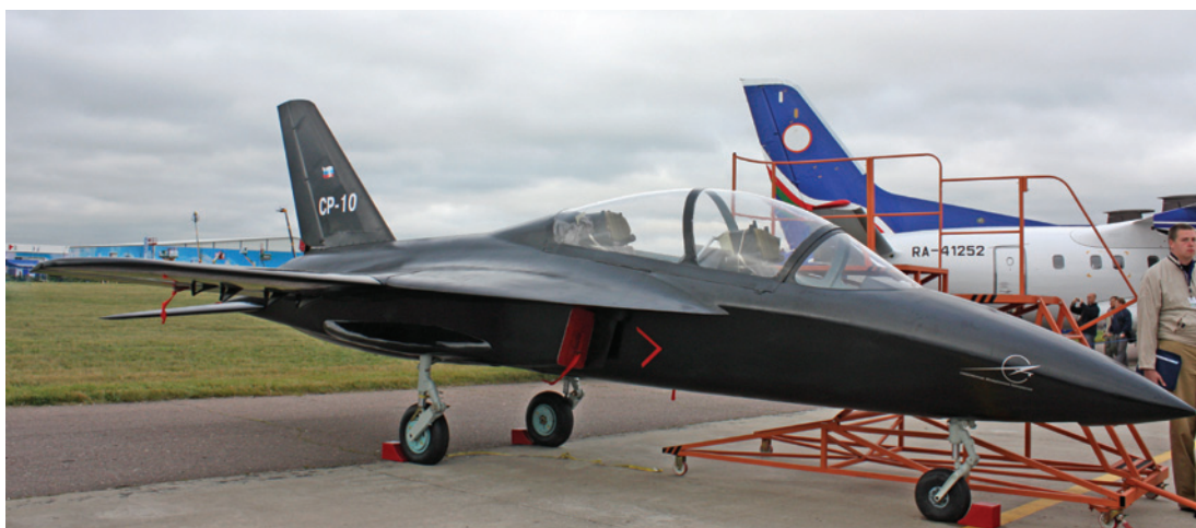
Самолет CP-10 — детали фюзеляжа, воздухозаборника; панели крыла, киля и др. конструкций из ПКМ
