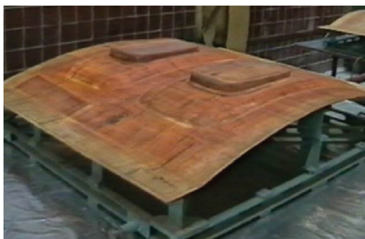
Полимерная выклеечная оснастка со встроенными неметаллическими нагревателями для изготовления конструкций интерьера самолета Ту-204-200
