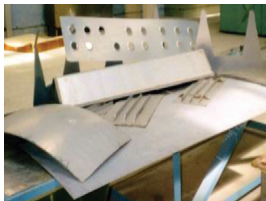
Конструктивные детали самолета Ан-124-100, изготовленные из МПКМ
