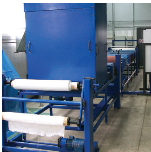
Изготовление препрегов на установке УПР-4
