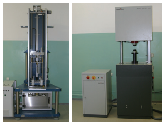
Высокочастотный пульсатор «Amsler» (Германия) и вертикальный копер «Coesfeld materialtest» (Германия)
