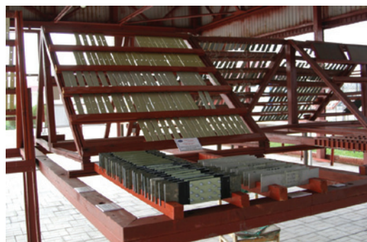
Ускоренно-натурные испытания алюминиевых сплавов под навесом ГЦКИ ВИАМ им. Г.В. Акимова (2012 г.)
