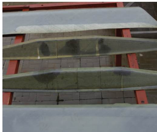
Климатические испытания элементов и конструктивных образцов из препрега фирмы «Hexcel» для самолета Ту-204СМ
