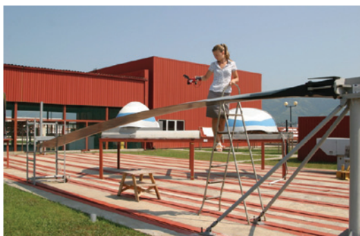
Измерение температуры поверхности и прогиба лопасти несущего винта вертолета Ми-28Н на силовом полу открытой атмосферной площадки ГЦКИ ВИАМ им. Г.В. Акимова (2011 г.)
