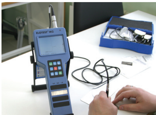
Универсальный портативный вихретоковый дефектоскоп «Elotest» (Германия)
