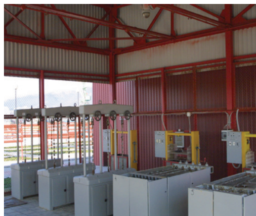
Установки «Сигнал» для переменного погружения в морскую воду и статического осевого нагружения (РФ)
