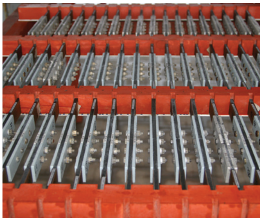
Коррозионные испытания соединений углепластиков с накладками алюминиевого сплава с различными вариантами крепежа
