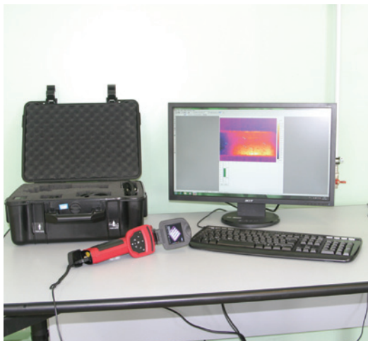
Тепловизор SDS Hot Find DXT для дистанционного замера температуры поверхности (США)
