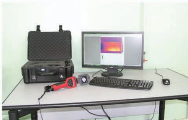
Тепловизор SDS Hot Find DXT для дистанционного замера температуры поверхности
