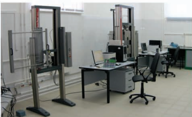
Машины Zwick Z10 и Z100 для проведения статических прочностных испытаний материалов
