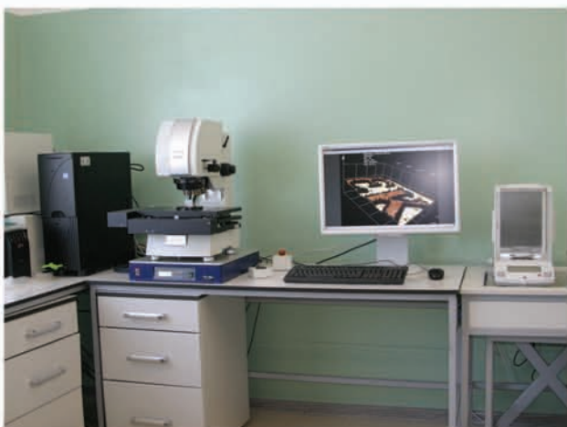
Лазерный сканирующий микроскоп LEXT (x14000)
