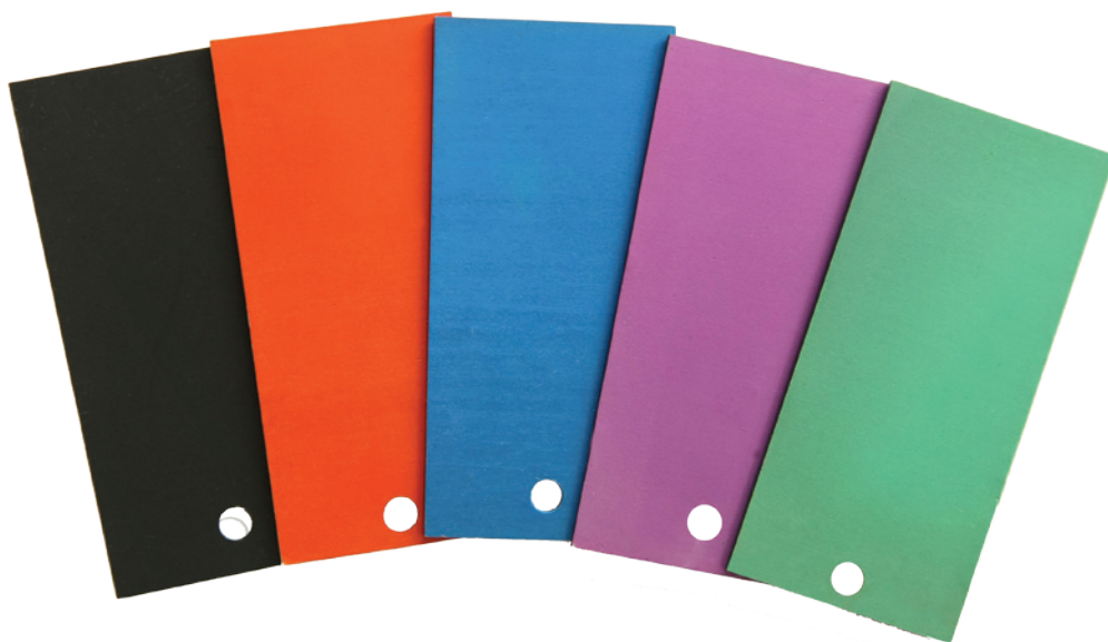
Образцы алюминиевого сплава с анодно-оксидным покрытием и последующим окрашиванием путем наполнения покрытия различными красителями
