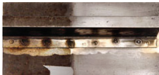
Фрагмент поверхности обшивки фюзеляжа из стали 1Х18Н10Т со стрингером до и после обработки пастой ВПТ-1
