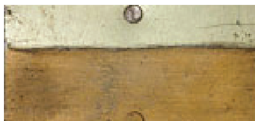
Участок поверхности обшивки фюзеляжа из алюминиевого сплава Д16-Т до и после обработки пастой ВПО-А по технологии местного химического оксидирования
