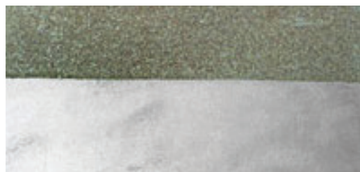
Фрагмент поверхности обшивки фюзеляжа из сплава Д16-Т до и после обработки пастой ВИП-А
