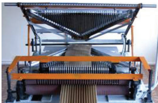
Установка для формования гофрированного и ячеистого заполнителей, изготовленная ООО «НПП ТУБОМАШ» (Россия) по ТЗ ВИАМ
