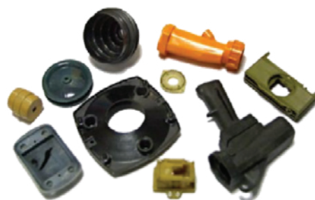
Детали краскораспылителя из литьевых термопластов
