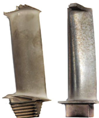
Рабочая лопатка турбины ГТД до и после удаления алюминийсодержащего покрытия в специальном растворе
