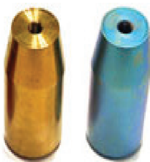
Детали рукоятки переключения передач автомобиля из сплава ВТ6, полученные методом анодного оксидирования
