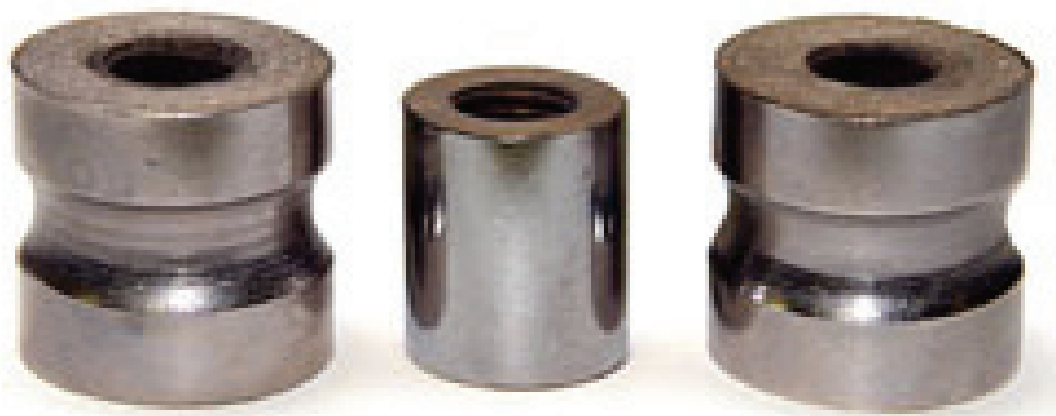
Втулки узлов трения из титановых сплавов с нанесенным пиролитическим карбидохромовым покрытием
