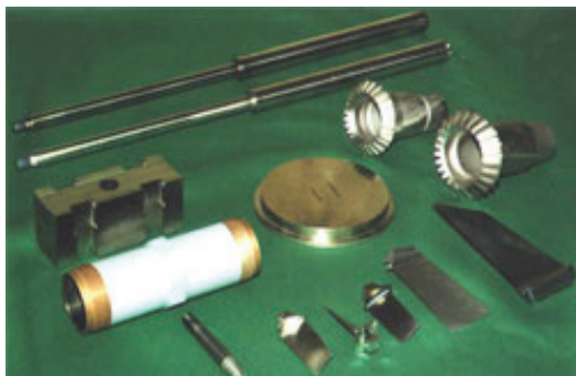
Штоки гидросистемы, фильера, пресс-форма, пружинозагрузатель с хромированными и никелированными покрытиями, полученными из электролитов с макро- и микрочастицами карбидов и оксидов металлов
