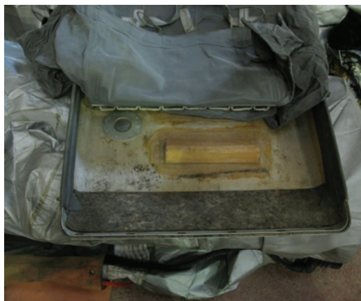
Контейнер для хранения комплекта спасательных трапов самолета Ту-204, пораженный микроорганизмами
